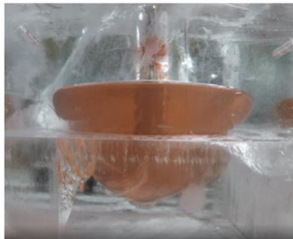
Poche d'eau créée dans une glace à -25^{\circ}\text{C} . La pointe du foret continue à tourner pour éviter le regel de l'eau.
